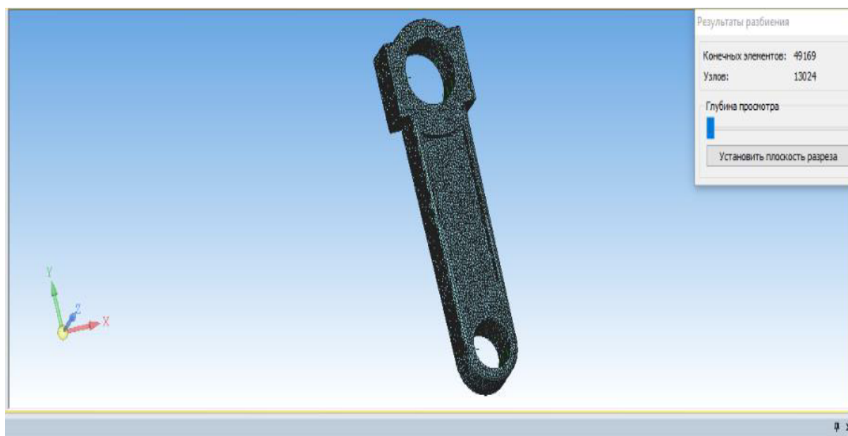
Рисунок 26 – Результат использования команды «Генерация КЭ сетки»
